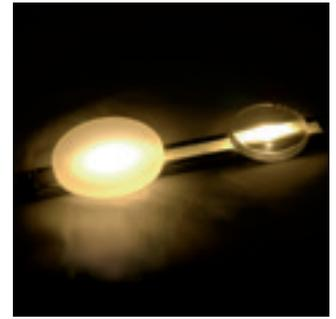
Entsprechende Änderungen der Farbtemperatur nach kontinuierlichem LED-Betrieb über 1000 Stunden
